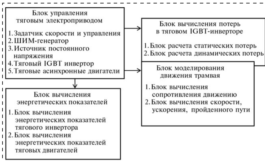
Рис. 2. Общий функциональный вид имитационной модели тягового электропривода трамвая в SimPowerSystems
