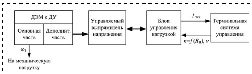
Рис. 1. Структурная схема управляемого электропривода на основе двухроторной электрической машины с дифференциальным управлением
