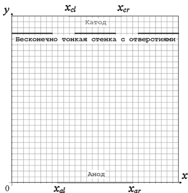
Рис. 1. Горизонтальное сечение гальванической ванны с сеткой по координатам x и y
