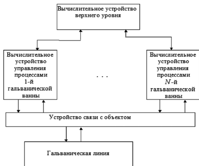
Рис. 4. Двухуровневая архитектура системы управления гальванической линией
